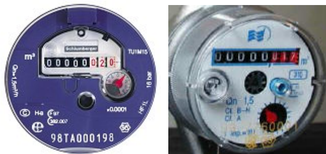
Figure 19 : Exemples de compteurs d'eau
